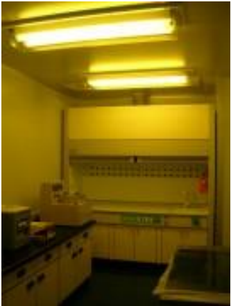
設備名稱：黃光室 設備用途：黃光微影 機台數量：2間 設備位置：工EV2007 工EV3007
