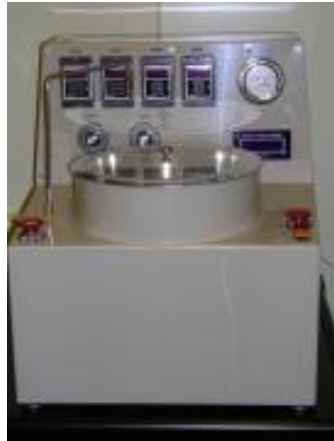
設備名稱：光阻塗佈機 設備用途：光阻塗佈 機台數量：2台 設備位置：工EV2007 工EV3007
