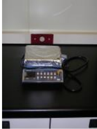
設備名稱：加熱平台 設備用途：試片軟硬烤 機台數量：3台 設備位置：工EV2007 工EV3007
