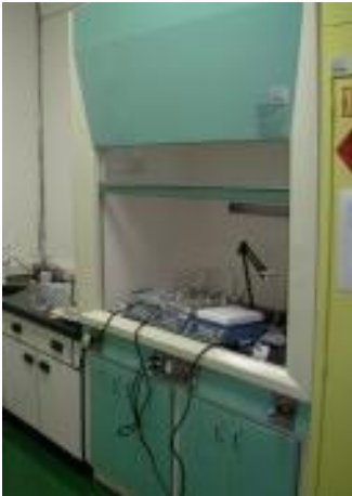
設備名稱：抽風櫃 設備用途：蝕刻 機台數量：3座 設備位置：工EV2007 工EV3007
